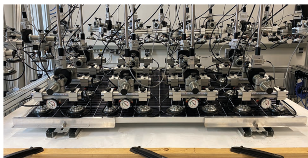
Prova di sollevamento SSM2 con cilindri pneumatici.
