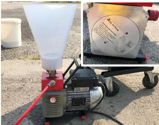
Versare la resina miscelata nel serbatoio della pompa e regolare la pressione di iniezione tramite apposito regolatore. Utilizzare pressioni di iniezione compatibili con la resina e il sistema di packer di iniezione.
