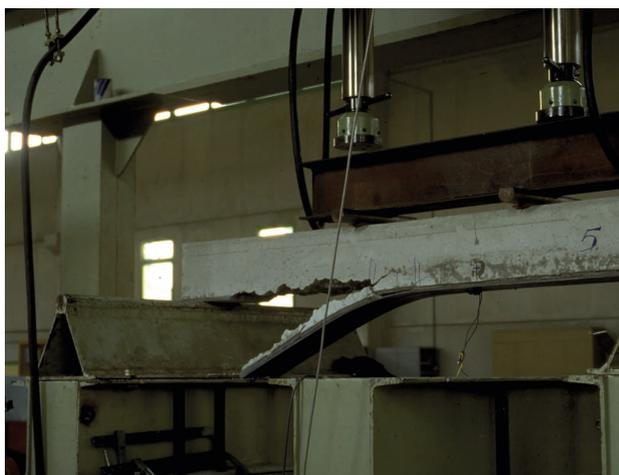
FIG. 6.1- Esempio di delaminazione di estremità
