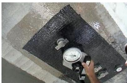
FIG. 2.5 - Esecuzione di prova pull-out
