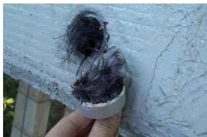
FIG. 2.6 - La prova di pull-out, l'impregnazione manuale non è corretta se il tessuto ha una grammatura elevata
