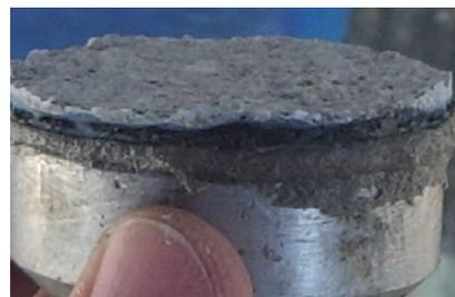
FIG. 2.7 - Le elevate grammature formano gruppi filamenti al cui interno l'adesivo non arriva
