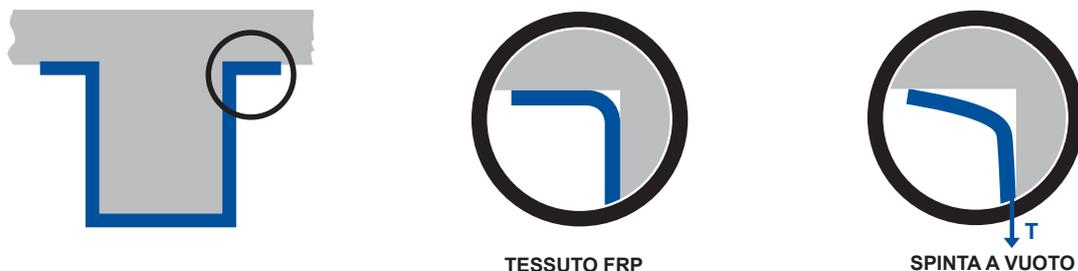
FIG. 6.3 - Esempio schematico del fenomeno di "spinta a vuoto"
