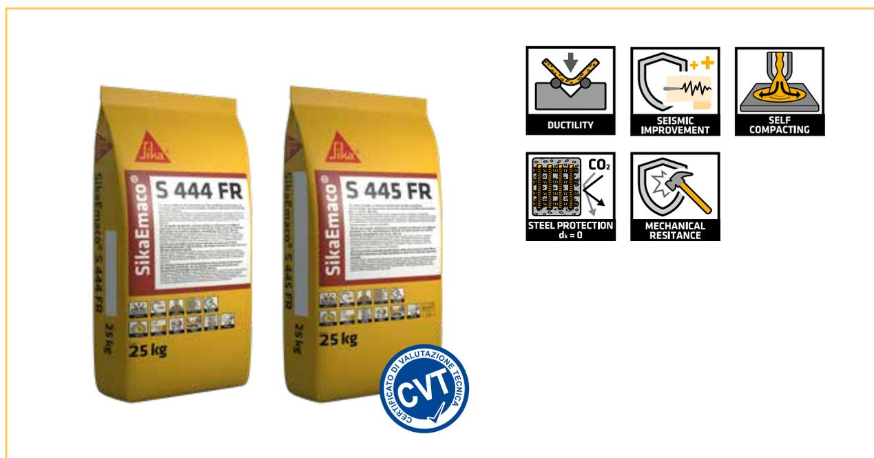
Le speciali fibre di acciaio contenute in **SikaEmaco<sup>®</sup> S 444 FR** e **SikaEmaco<sup>®</sup> S 445 FR** hanno una lunghezza di 30 mm, diametro di 0,38 mm e forma a "catino", con una resistenza a trazione > 3070 MPa e modulo elastico pari a 210 GPa. Grazie al rinforzo fibroso le malte hanno un comportamento fortemente duttile che garantisce la resistenza alle sollecitazioni dinamiche ed urti, anche in assenza di armature aggiuntive.
