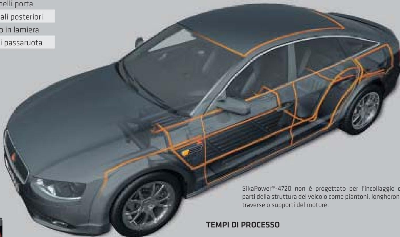
SikaPower®-4720 non è progettato per l'incollaggio di parti della struttura del veicolo come piantoni, longheroni, traverse o supporti del motore.
