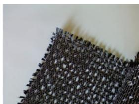
Rinforzo fibroso a base di tessuti unidirezionali in fibra di carbonio del sistema SikaWrap® FRP (Fiber Reinforced Polymer). Approvato con C.V.T. (Certificato di Valutazione Tecnica).
