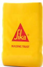
SikaMur®-222 IT è una boiaccia premiscelata a base di calce idraulica naturale, esente da cemento, a granulometria finissima, ad elevata fluidità ed eccellente lavorabilità. È anche espansiva in fase plastica, per garantire anche il riempimento dei vuoti più piccoli.
