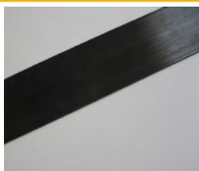
Lamine pultruse in fibra di carbonio del sistema Sika® CarboDur® LAM (Fiber Reinforced Polymer) indicate per il rinforzo di elementi in calcestruzzo, legno ed acciaio.
