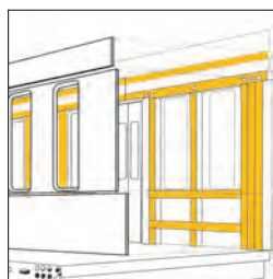
Incollaggio di componenti interne
