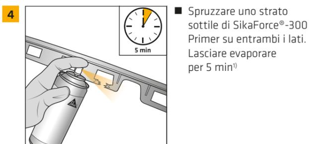
4 ■ Spruzzare uno strato sottile di SikaForce®-300 Primer su entrambi i lati. Lasciare evaporare per 5 min<sup>1)</sup>
