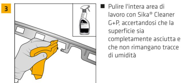
3 ■ Pulire l'intera area di lavoro con Sika® Cleaner G+P, accertandosi che la superficie sia completamente asciutta e che non rimangano tracce di umidità
