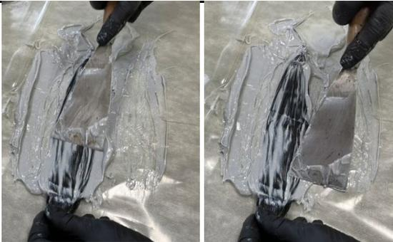
Impregnare il connettore con Sikadur®-330 fino a completa saturazione. Mantenere un'estremità asciutta (circa 3 cm).
