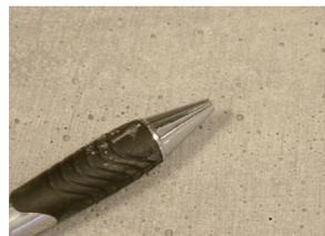
Particolare di una superficie di malta dopo prova del sottopiastra con esito positivo: sostanziale assenza di bolle in interfaccia (nella foto prova condotta con SikaGrout®-928).
