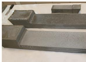
Test condotto secondo ASTM C1339-02 („Standard Test Method for Flowability and Bearing Area of Chemical-Resistant Polymer Machinery Grouts“) per la verifica della qualità della superficie di interfaccia.
