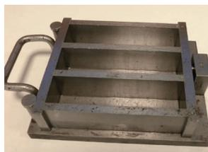
Casseri metallici per le prove di resistenza a compressione ed a trazione per flessione delle malte per ancoraggio (UNI EN 12190)
