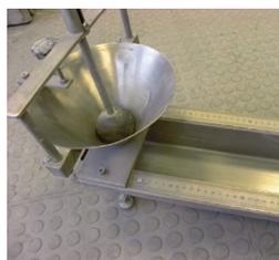
Particolare del volume da riempire con la malta di prova: una volta riempito si apre il foro sul fondo permettendo al materiale di scorrere e si procede poi a misurare la lunghezza di scorrimento nella scala centimetrica presente nella canaletta dello strumento
