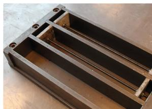
Casseforme per il confezionamento di provini per la prova di espansione contrastata delle malte da ancoraggio (UNI 8147)
