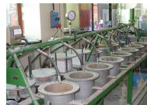
Prova di impermeabilità all'acqua secondo UNI EN 12390/8
