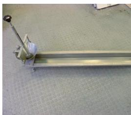
Foto prova di consistenza - misurazione dello scorrimento (UNI 8997)
