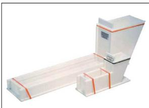
Sottopiastra in plexiglass per la valutazione della quantità e della dimensione delle bolle d'aria in interfaccia.
