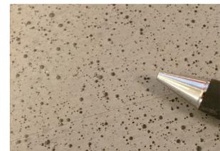
Particolare di una superficie di malta dopo prova del sottopiastra non accettabile: presenza di eccessivo numero di bolle in interfaccia anche di ampie dimensioni.
