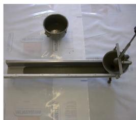
Esempio di prova di misurazione dello scorrimento; per i materiali ad elevata velocità di scorrimento il tempo necessario per raggiungere la lunghezza di scorrimento prevista da normativa è molto importante.
