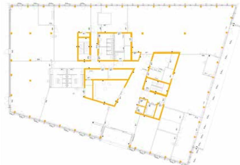
La struttura dell'edificio principale è composta da un nucleo in cemento armato gettato in opera che è sostenuto esternamente da pilastrini in calcestruzzo prefabbricato. I pilastrini prefabbricati sono stati fissati meccanicamente e poi stuccati in sede con SikaGrout®-314.
