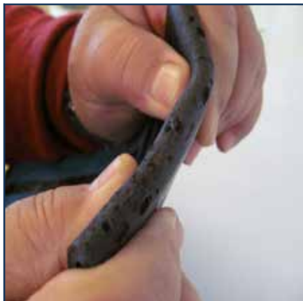
...dopo 1 piegamento screpola
