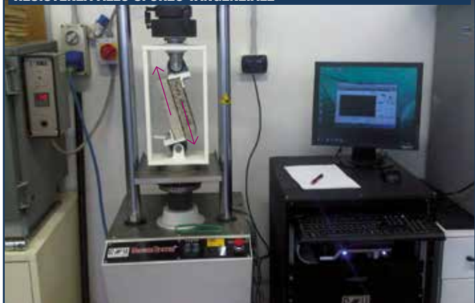
MISURA AL DINAMOMETRO DELLA FORZA DI ADESIONE
