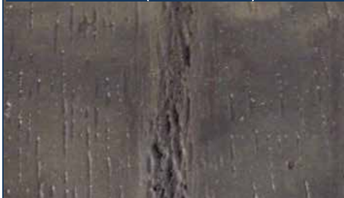
MEMBRANA SUPERCARICATA IN VOLUME CON MICROSFERE DI VETRO (DOPO 10 PIEGAMENTI)
