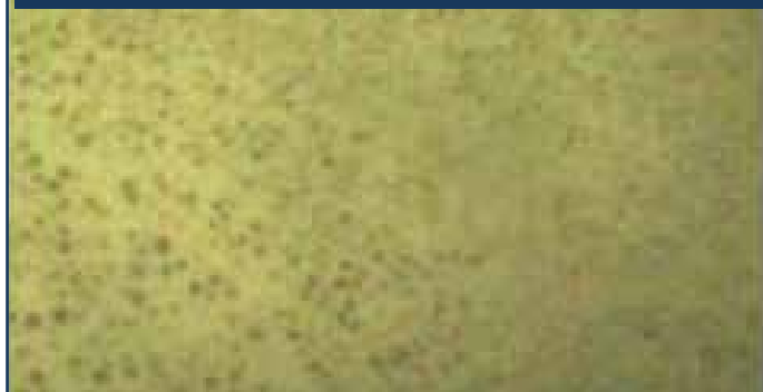
ESEMPI DI STRUTTURA - MESCOLE A FASE CONTINUA BITUMINOSA, LE MACCHIE GIALLE DI POLIMERO SONO INGLOBATE NELLA MATRICE DI BITUME, LA CONCENTRAZIONE DI POLIMERO È INSUFFICIENTE E/O IL BITUME È INCOMPATIBILE
