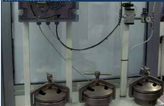
PROVA DI FATICA SU FESSURA PER VALUTARE LA RESISTENZA DELLA MEMBRANA INCOLLATA SUL SUPPORTO IN CLS
