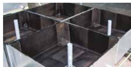
2. Vasche di prova impermeabilizzate
