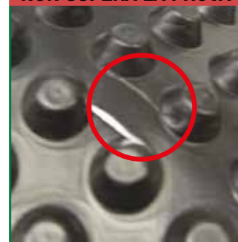
FOGLIO HDPE BUGNATO NON SUPERA LA PROVA
