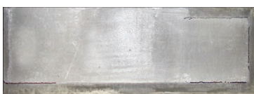
"Baenziger Block" riempito con una malta con un buon comportamento alla fessurazione
