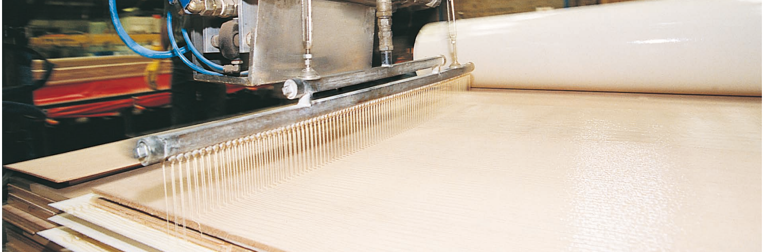
SikaForce® applicato tramite spargitore
