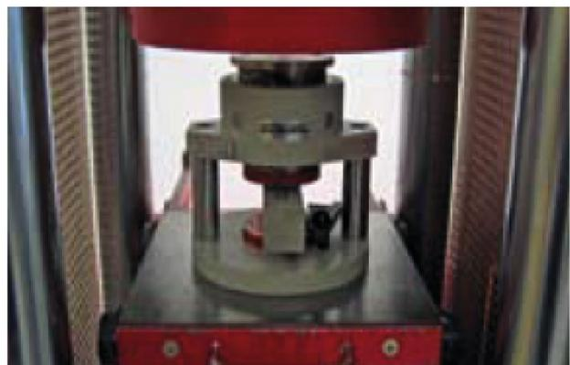
Le **resistenze meccaniche degli SikaEmaco® T** sono elevatissime (ad esempio resistenze a compressione dell'ordine degli 85 MPa dopo 28 giorni). Inoltre grazie alla bassissima porosità della matrice, i prodotti SikaEmaco® T sono particolarmente resistenti al contatto con idrocarburi come olio, benzina, gasolio ed alle sollecitazioni da gelo-disgelo.
