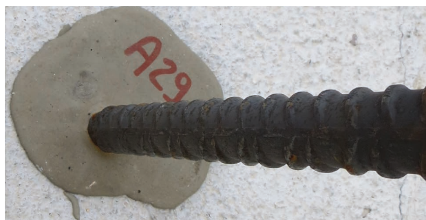
ANCORAGGIO BARRE AD ADERENZA MIGLIORATA
