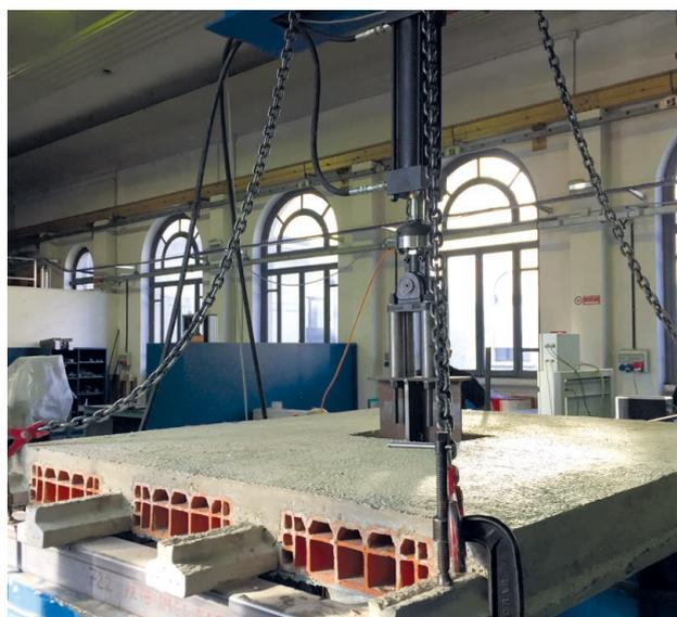
Provino di solaio in scala reale: prove sperimentali eseguite presso il laboratorio prove materiali del **Politecnico di Milano**.
