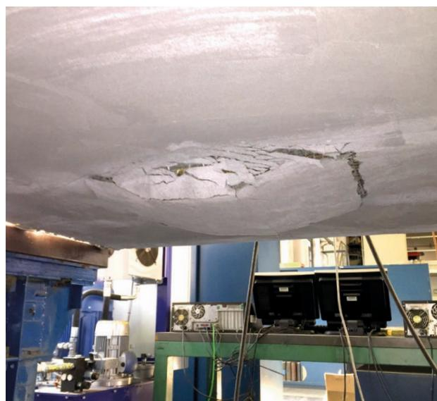
Meccanismo di rottura di un provino di solaio in scala reale rinforzato con Sika® Safe RM, dopo applicazione di un **carico di circa 900 kg** su singola pignatta.
