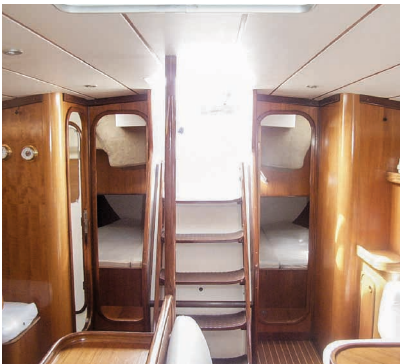
Pannelli leggeri di alta qualità rifiniti con impiallacciatura tradizionale in legno lucido e incollati con Sikaflex®-292i
