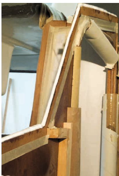
Sikaflex®-292i applicato ad un pannello leggero prima del montaggio
