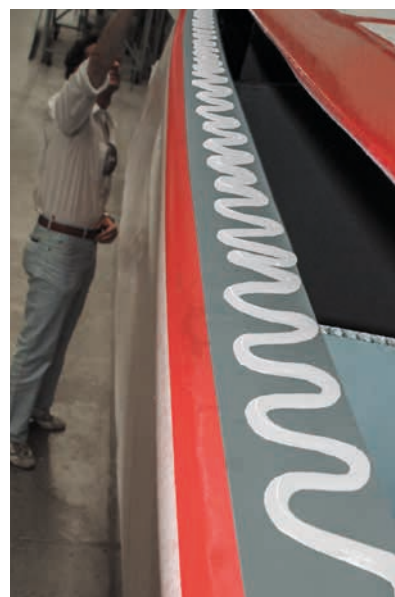
Scafo e ponte vengono uniti
