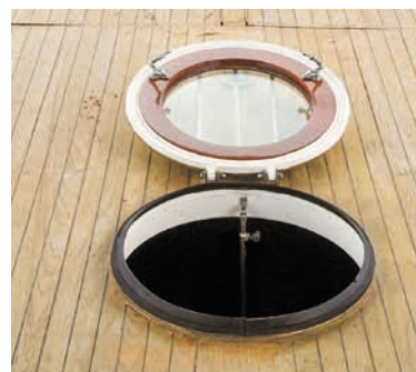
Portello, sia incollato che sigillato con Sikaflex®
