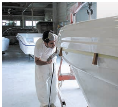
Sigillatura con Sikaflex®-295 UV
