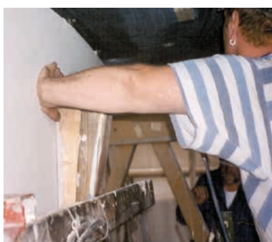
Chiglia accuratamente inserita in posizione
