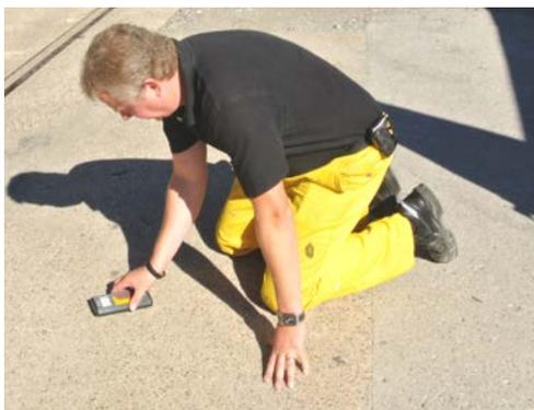
Il contenuto di umidità del supporto deve essere < 4% in peso. I dispositivi idonei per la misurazione sono l’igrometro al contatto **Sika Tramex** o l’igrometro al carburo che descriveremo in seguito. L’igrometro al contatto è molto semplice: basta appoggiare al supporto lo strumento e leggere il valore dell’umidità sul dispositivo.
