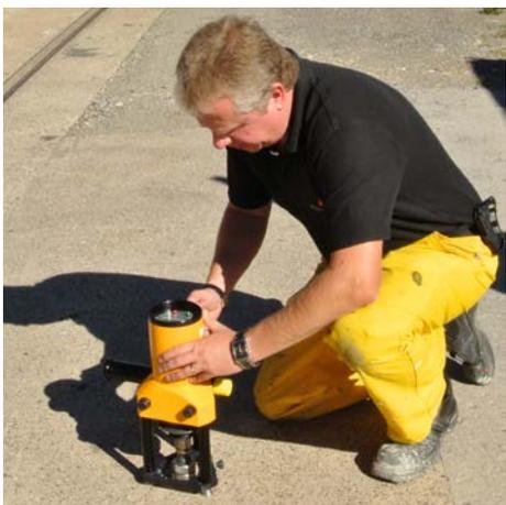
Misurazione della resistenza a trazione > 1 N/mm<sup>2</sup> con lo strumento tipo BPS Wennigsen Easy M.
