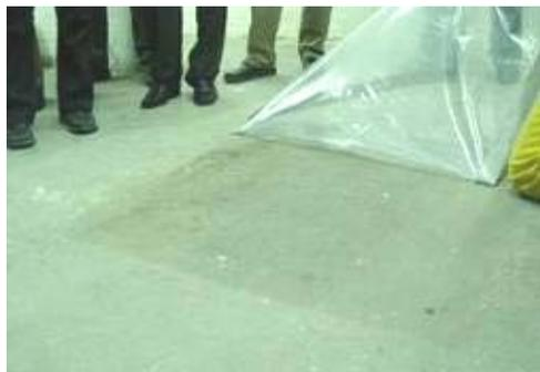
Ad una umidità del calcestruzzo di > 4% PBW applicare un malta epossicamento tricomponente per abbattere temporaneamente all'umidità di risalita, **Sikafloor®-81 EpoCem**, (consultare la Scheda Sikafloor®-81 EpoCem).
