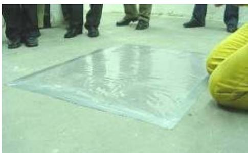
Un altro metodo per la misura dell'umidità è quella del foglio di plastica. Il sistema è modo rapido, semplice, non distruttivo, e poco costoso. Tuttavia esso non fornisce alcun risultato quantitativo. In caso di dubbio il metodo del carburo di calcio deve essere utilizzato.
