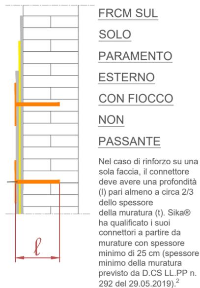
Nel caso di rinforzo su una sola faccia, il connettore deve avere una profondità (l) pari almeno a circa 2/3 dello spessore della muratura (t). Sika® ha qualificato i suoi connettori a partire da murature con spessore minimo di 25 cm (spessore minimo della muratura previsto da D.CS LL.PP n. 292 del 29.05.2019).<sup>2</sup>
