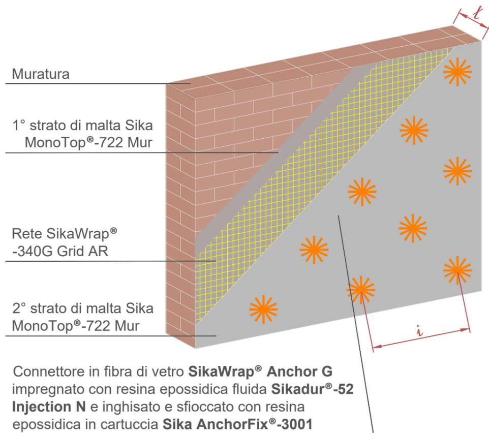
Connettore in fibra di vetro **SikaWrap® Anchor G** impregnato con resina epossidica fluida **Sikadur®-52 Injection N** e inghisato e sfioccato con resina epossidica in cartuccia **Sika AnchorFix®-3001**
