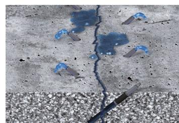
**3.** Fissare la valvola di non ritorno sul primo adattatore ed iniziare il processo di iniezione.
