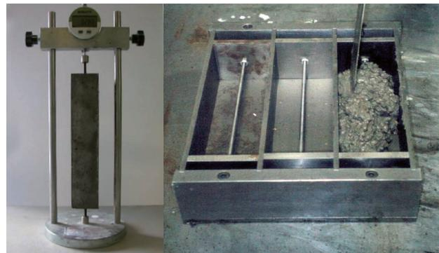
Prova di determinazione dell'espansione contrastata di malte (UNI 8147) o calcestruzzo (UNI 8148)
