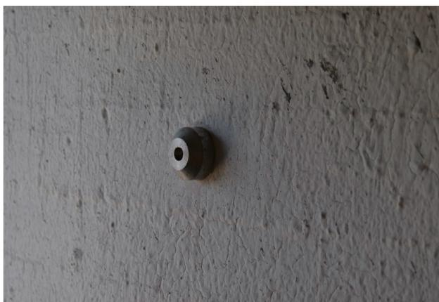
Prove di adesione secondo UNI EN 1542. Possono valutare l'adesione di una malta sul calcestruzzo di supporto, oppure di una verniciatura protettiva
