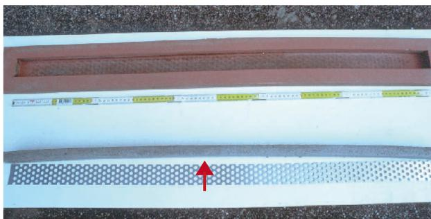
Esempio di prova che evidenzia un comportamento espansivo della malta (inarcamento)
