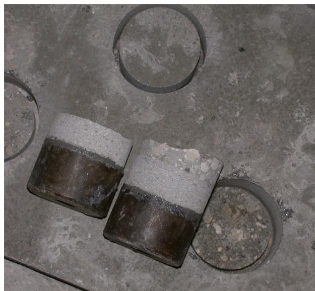
Prove di pull-out per verificare l'adesione della malta al supporto
