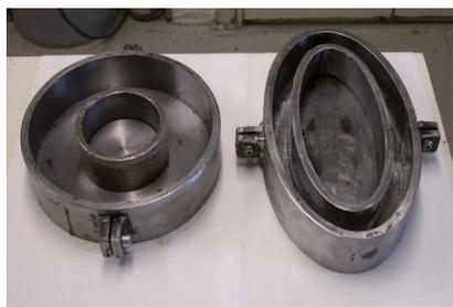
Valutazione della tendenza alla fessurazione di malte con prova di O-Ring Test (circolare ed ellittico)
