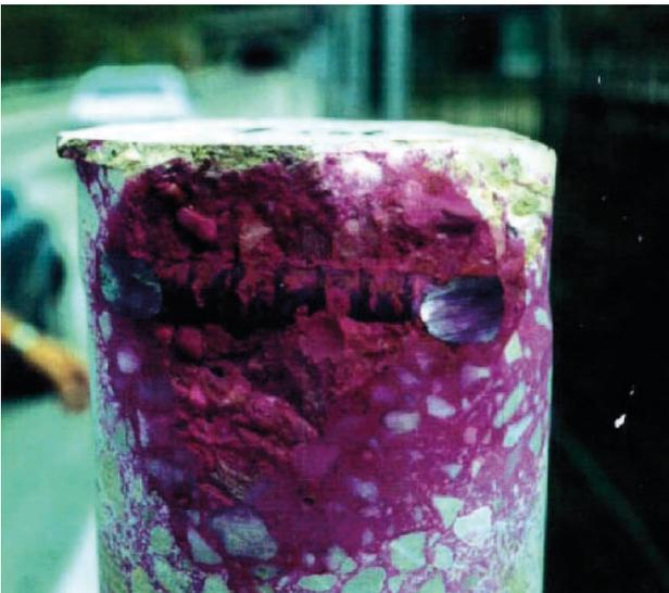
Esempio di valutazione della profondità di carbonatazione su carota (la parte colorata non è carbonatata, mentre la parte incolore è carbonatata)
