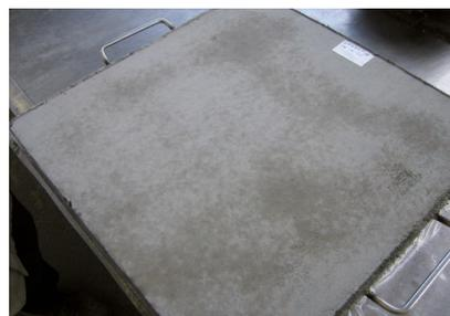
Altra prova per la determinazione della tendenza a fessurazione del prodotto (la malta da testare viene applicata sulla piastra di sinistra e poi stagionata per 24 ore in camera climatica a 40°C con il 30% U.R. e ventilazione in modo da favorire l'insorgere delle fessurazioni da ritiro)
