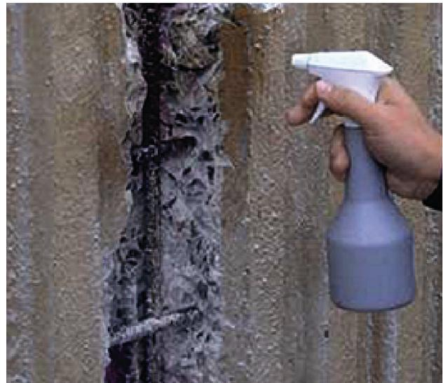
Valutazione della profondità di carbonatazione su sondaggio eseguito direttamente sulla struttura
