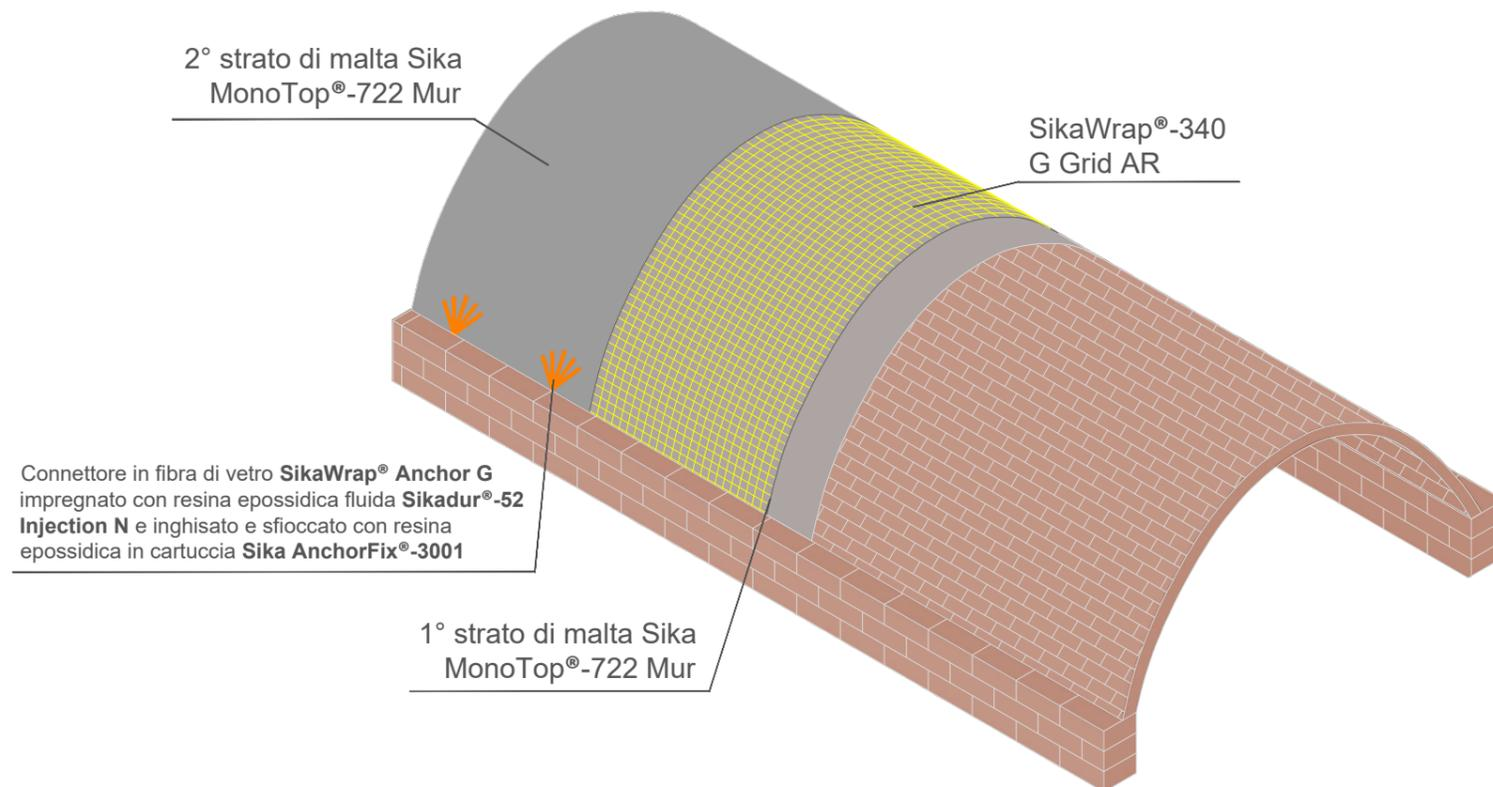
Connettore in fibra di vetro **SikaWrap® Anchor G** impregnato con resina epossidica fluida **Sikadur®-52 Injection N** e inghisato e sfocciato con resina epossidica in cartuccia **Sika AnchorFix®-3001**
