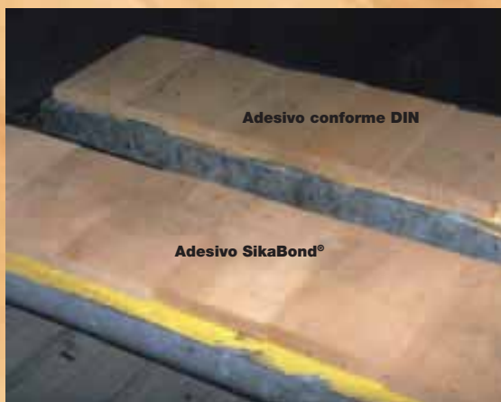
Fig. 5: Test in condizioni estreme: tavole in faggio massicci, spessi 21 mm, contenuto di umidità del legno del 22 %
