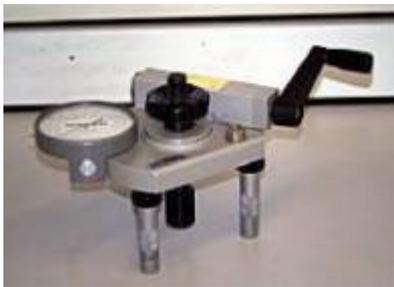
In caso di dubbio, realizzare prima un'area di prova e confermarla con l'apparecchiatura di prova della forza di adesione, come mostrato a sinistra. (Proceq o simili)
