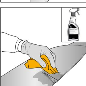
**6** Pulire l'intera area di lavoro con Sika® Cleaner G+P, accertandosi che la superficie sia completamente asciutta e che non rimangano tracce di umidità
