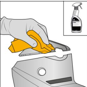
**3** Pulire l'intera area di lavoro con Sika® Cleaner G+P, accertandosi che la superficie sia completamente asciutta e che non rimangano tracce di umidità
