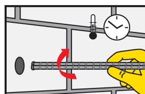
9. Inserire l'ancoraggio con un movimento rotatorio nel foro colmato di adesivo. L'adesivo deve fuoriuscire dal foro.
