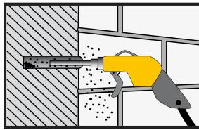
2. Il foro deve essere pulito con aria compressa (con apposita pistola), partendo dal fondo del foro. Ripetere almeno 2 volte o fino a che l'aria in uscita dal foro non risulti pulita. Importante: impiegare dispositivi ad aria compressa senza olio, con pressione min. 6 bar (90 psi).
