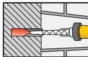
8. Iniettare l'adesivo partendo dal fondo del foro, estraendo contemporaneamente e lentamente il miscelatore statico. Si deve in ogni caso evitare l'inclusione di aria. Per fori profondi può essere utilizzato un tubo di estensione.
