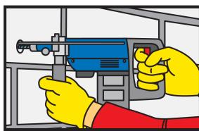
1. Praticare il foro, con diametro e profondità richiesti, con il trapano. Il diametro del foro e la barra d'ancoraggio devono in ogni caso corrispondere.
