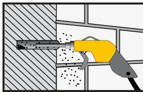
4. Il foro deve essere pulito con aria compressa (con apposita pistola), partendo dal fondo del foro. Ripetere almeno 2 volte o fino a che l'aria in uscita dal foro non risulti pulita. Importante: impiegare dispositivi ad aria compressa senza olio, con pressione min. 6 bar (90 psi).
