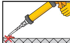
7. Per ogni cartuccia nuova, oppure dopo aver cambiato il miscelatore statico, le prime estrusioni non possono essere utilizzate, fino a che non si consegne un colore uniforme. Pulire il beccuccio con un panno prima di applicare il prodotto.
