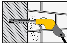
6. Il foro deve essere pulito con aria compressa (con apposita pistola), partendo dal fondo del foro. Ripetere almeno 2 volte o fino a che l'aria in uscita dal foro non risulti pulita. Importante: impiegare dispositivi ad aria compressa senza olio, con pressione min. 6 bar (90 psi).
