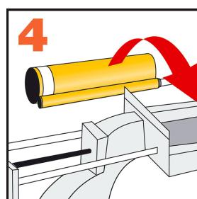
Quando il lavoro viene interrotto il miscelatore statico può rimanere sulla cartuccia dopo che è stata ridotta la pressione della pistola d'applicazione. Quando si riprende il lavoro, se la resina è indurita all'interno del miscelatore statico, è necessario montare un nuovo miscelatore statico.
