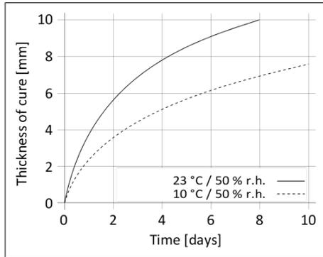
Diagramma 1: velocità di indurimento di Sikaflex®-291i
