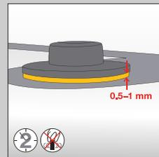
Comprimere fino ad uno spessore di incollaggio di 0.5-1 mm entro il tempo aperto dell'adesivo. Se necessario, fissare la basetta con nastro adesivo (vedere tabella, colonna 1).
