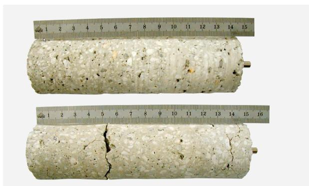
Il deterioramento del calcestruzzo dovuto all'attacco di solfati prima e dopo il carico, mostra un forte aumento della lunghezza a causa dell'attacco delle scheggiature. Le prime crepe compaiono nel campione.
