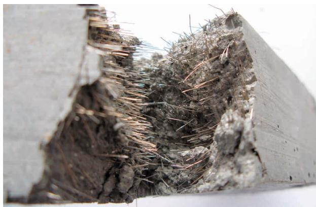
Il calcestruzzo ad alta resistenza e, soprattutto, ad altissima resistenza è praticamente sempre rinforzato anche con fibre. A seconda delle esigenze, le fibre sintetiche e / o d'acciaio vengono quindi impiegate in grandi quantità. L'elevata resistenza alla flessione di UHPC può essere raggiunta in questo modo.
