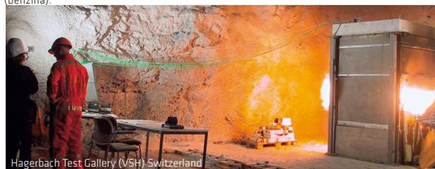
In speciali camere forno possono essere replicate le traiettorie del fuoco, i pannelli possono essere testati e successivamente valutati. Lo sviluppo della temperatura viene misurato e registrato a varie profondità.
