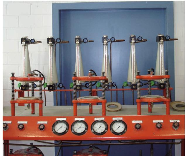
L'assorbimento d'acqua del calcestruzzo sotto pressione misura la massima penetrazione d'acqua in mm dopo un tempo definito con una pressione specificata. (24 ore con 5 bar secondo EN12390-8)
