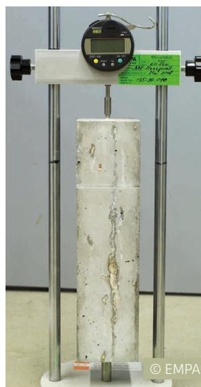
L'aumento di volume dovuto al carico derivante dall'ASR diventa percettibile misurando la variazione di lunghezza nei campioni di prova. Normalmente i campioni vengono tenuti a condizioni più intense (temperatura, umidità, carico applicato) per accelerare la reazione.
