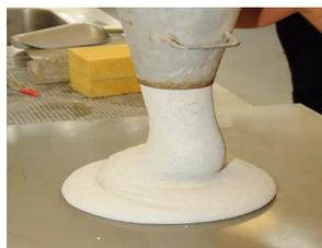
Con una resistenza alla compressione superiore a 150 Mpa non si parla più di comune calcestruzzo. Gli aggregati di pietra sono sostituiti ad esempio da aggregati sottili di origine ceramica e l'intera matrice legante ricorda solo leggermente il calcestruzzo classico. Nella figura è mostrato il comportamento del flusso di un UHPC di 200 MPa.
