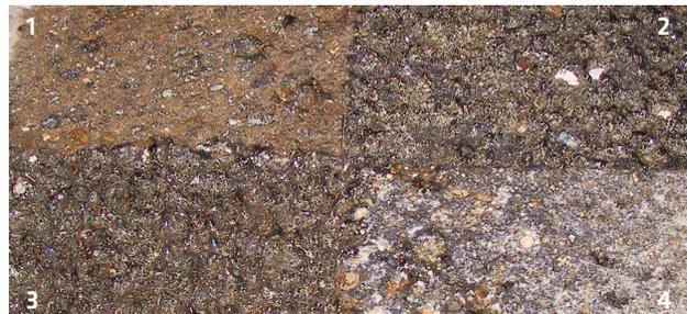
Prove di esposizione al fuoco su calcestruzzo contenente vari aggregati. La scheggiatura superficiale e la sinterizzazione, e una gamma di temperature a diverse profondità, possono essere quindi messi a confronto..
