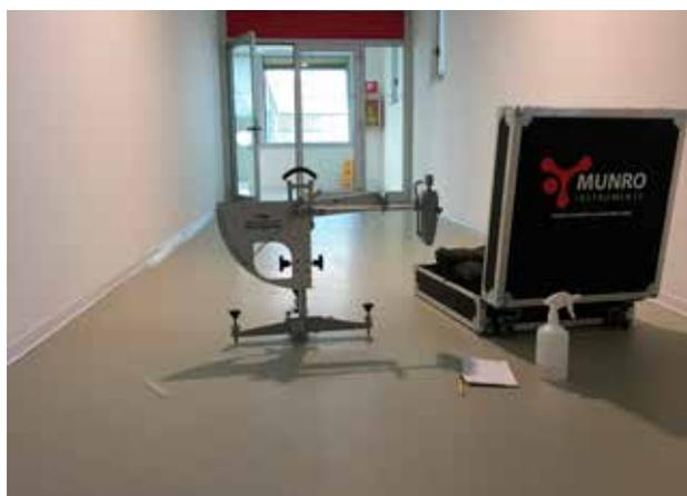
Il risultato ottenuto con il metodo del pendolo nelle aree comuni su superficie asciutta è un valore compreso tra 67 e 74: questo risultato fa rientrare il pavimento in un potenziale di scivolamento "estremamente basso".
