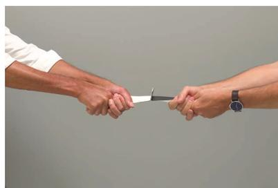
Resistenza a taglio delle giunzioni saldate 3 volte superiore rispetto ai manti in EPDM, per una tenuta all'acqua durevole nel tempo.
